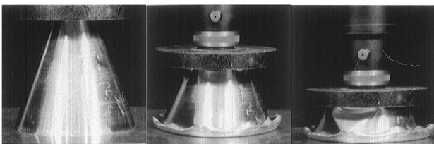
图 1 锥壳在万能力学试验机压缩下的坍塌过程 [4]
