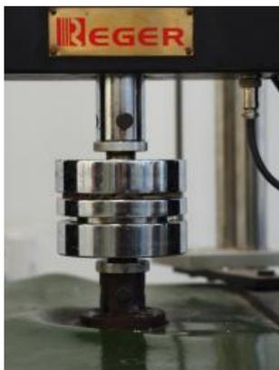
图1 瓦楞纸板平压试验图
