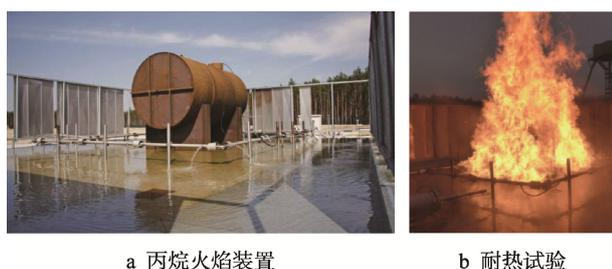
图 2 德国联邦材料测试中心丙烷火焰耐热试验
