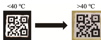
图4 油墨的热敏变色照片
