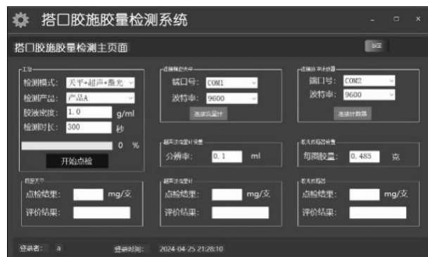
图6 搭口胶施胶量检测上位机软件主页面
