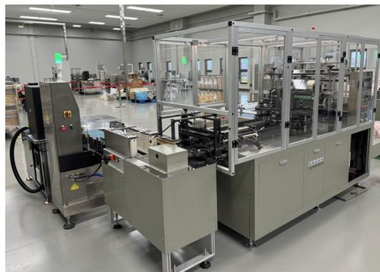
图 12 雪茄条盒透明纸包装机
