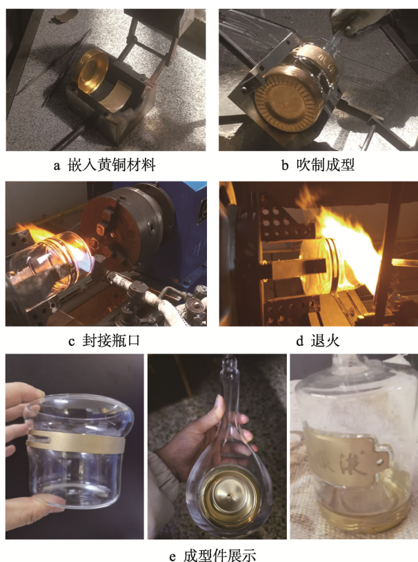
图 5 黄铜-玻璃模内成型实验
