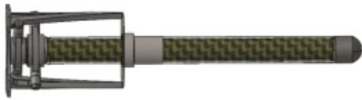
图 4 扭杆弹簧压缩后结构
