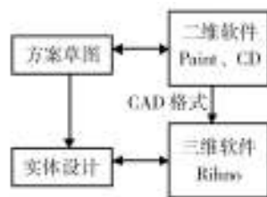
图4 基于数字化技术的设计草图到设计实体的转换
