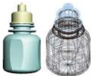
图9 适当减少壁厚的瓶身人性化设计改进
