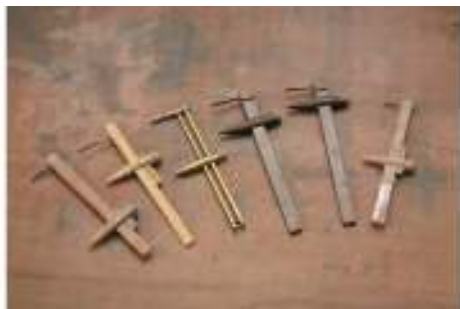
图1 硬木或竹老头制成的矩车
