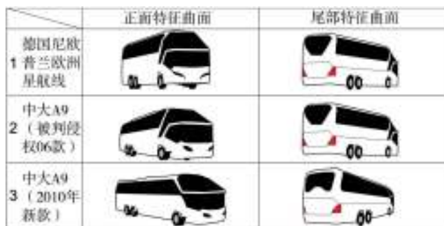
图4 正面透视图和尾部透视图的特征曲面提取
