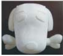
图4 儿童刷牙牙膏架快速成型结果
