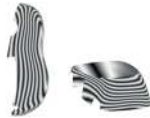
图2 儿童牙刷牙膏架上盖、下盖曲面斑马线分析
