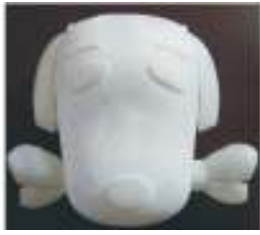
图4 儿童刷牙牙膏架快速成型结果
