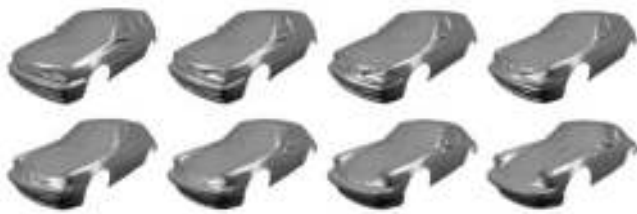
图4 基于投影的(单位圆盘)汽车变形过程
