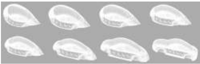
图5 基于投影的(单位球)汽车变形过程
