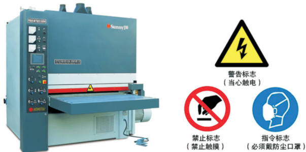
图1 木工机械产品中安全色的使用
