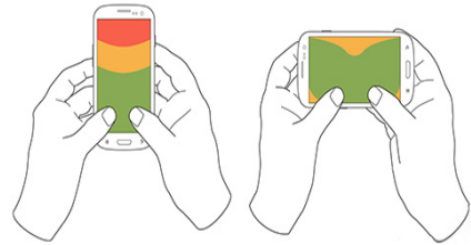
图 3 手机屏幕上的手指覆盖区域 Fig.3 Finger coverage area on the phone screen
