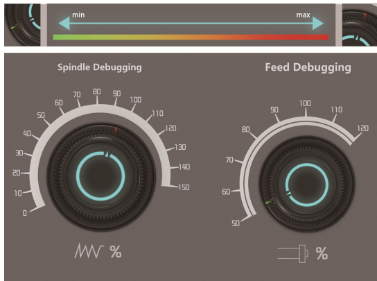
图4 旋钮细节设计 Fig.4 Knob design details
