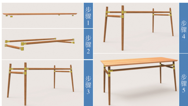
图 5 安装步骤 Fig.5 Installation steps
