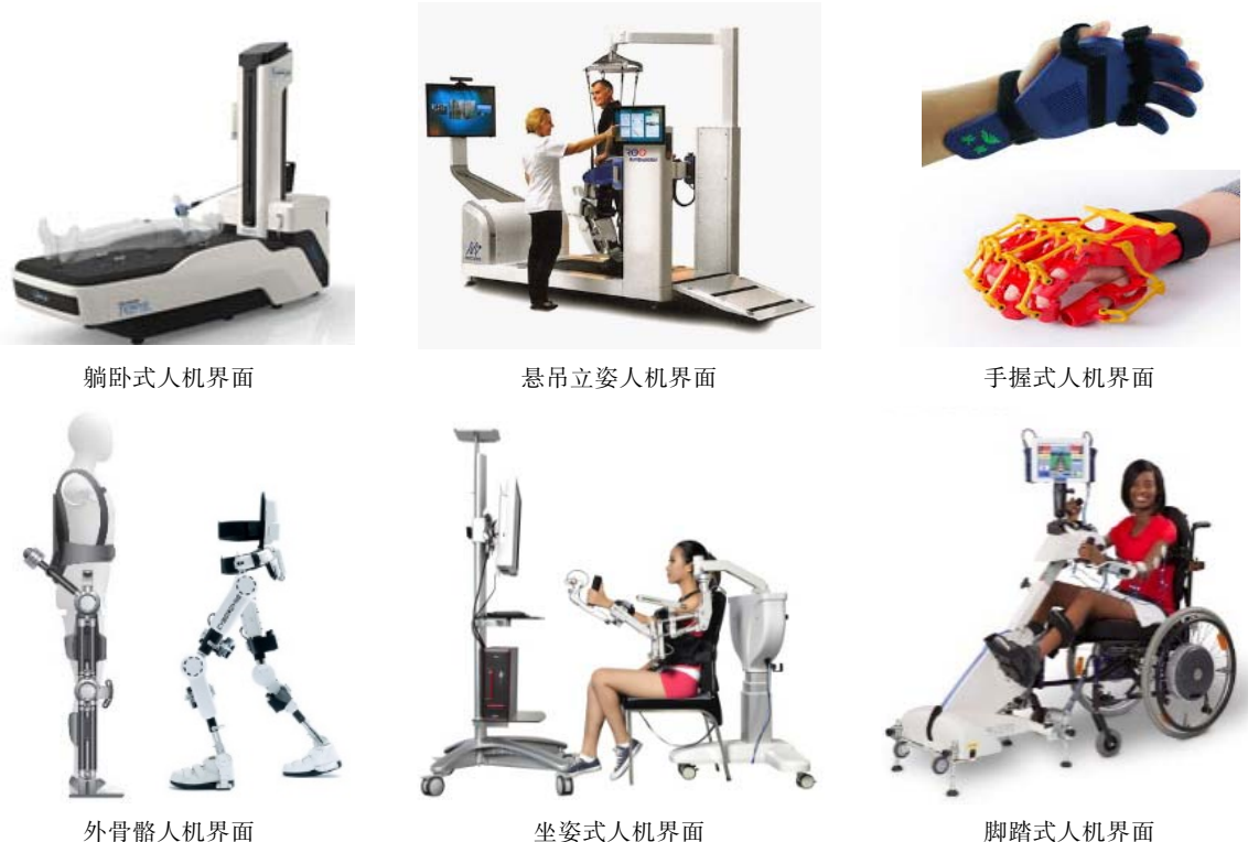
图 2 康复机器人 HRI 人机界面 Fig.2 Human-robot interface of rehabilitation robot
