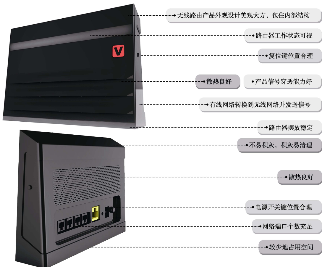
图 6 无线路由器设计结果 Fig.6 Design results of wireless router
