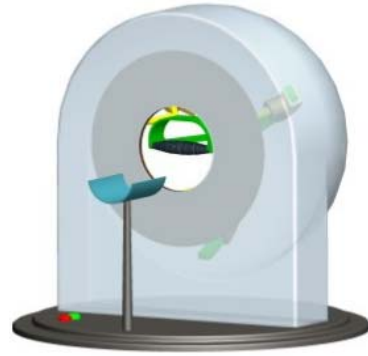
图 6 手腕外骨骼康复机器人 Fig.6 Wrist exoskeleton rehabilitation robot
