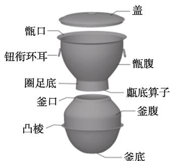
图 10 铜甑结构名称示意
