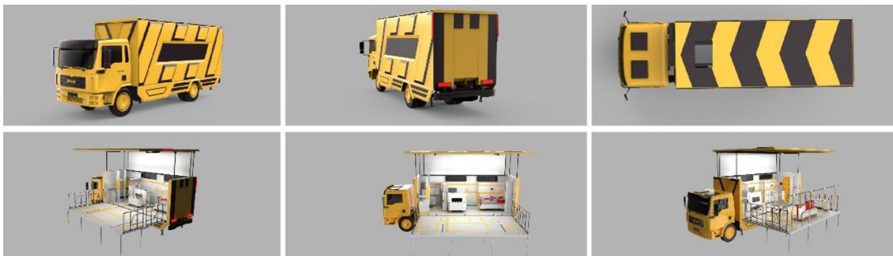
图 6 可移动电力检测设备设计方案
