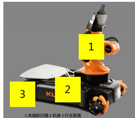
图 2 德国 KUKA 移动式机器人
