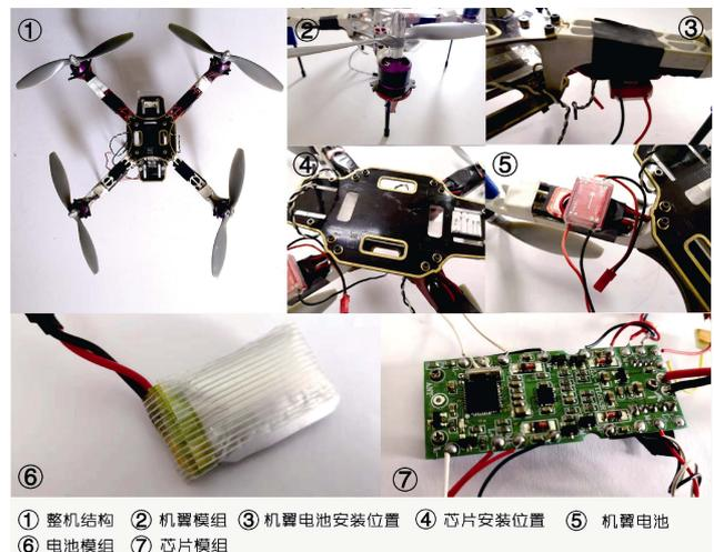
图 16 产品样机内部元器件设计探索
