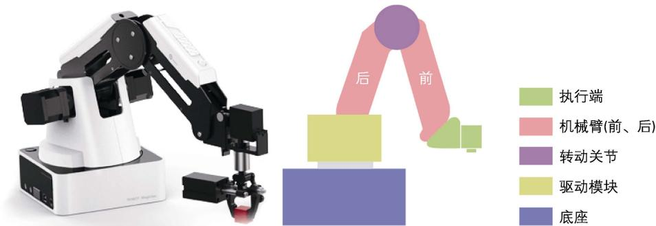
图1 教育型桌面机械臂的侧视图及组成
