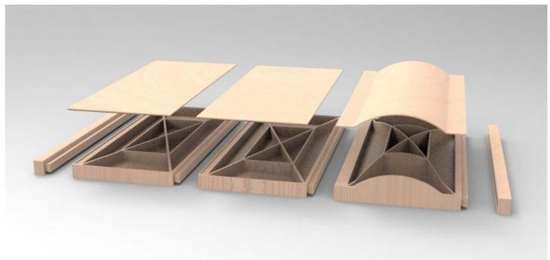
图 7 底层结构框架
