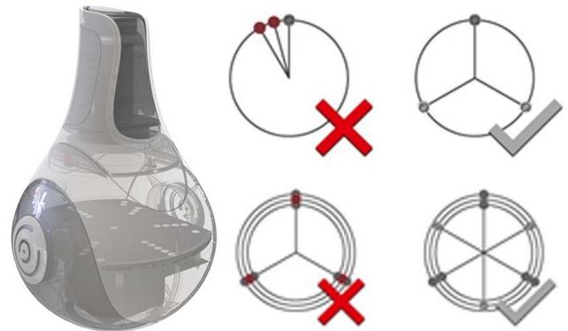
图8 相邻圆环上的光敏电阻错位 $180^\circ$ 布置
