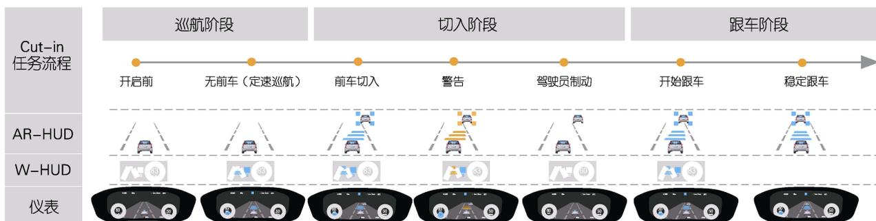
图 6 cut-in 场景下的多屏 HMI 设计方案
