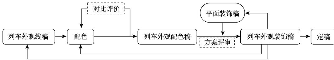
图 1 城轨外观装饰概念设计流程
