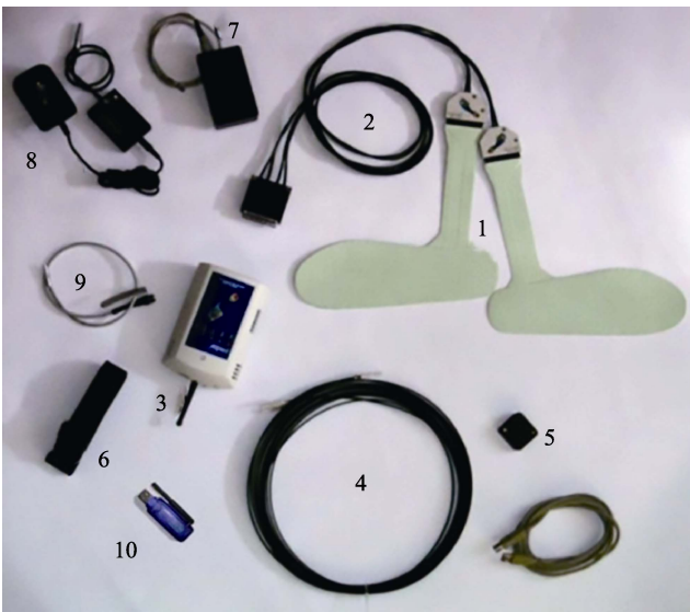
1—压力鞋垫; 2—连接线; 3—蓝牙接收装置; 4—数据传输光纤; 5—USB适配器; 6—弹力绑带; 7—电池及连接线; 8—电池充电器; 9—触发装置; 10—蓝牙密码狗。
