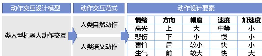
图4 类人型机器人情感动作交互设计参考模型
