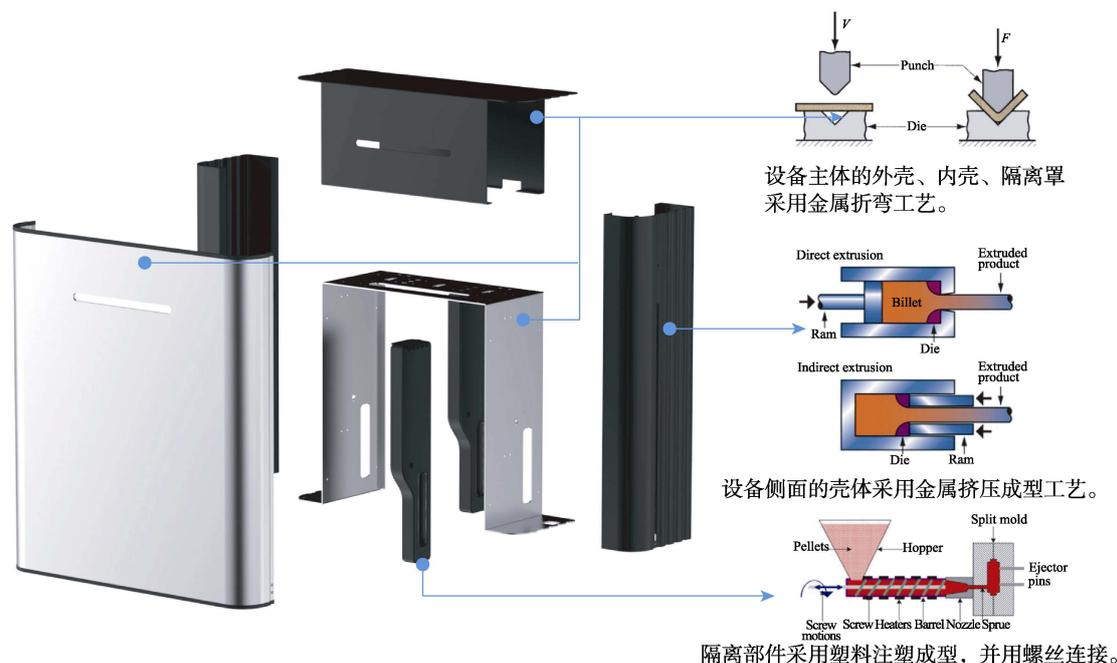
图 15 设备各部件的制造工艺
