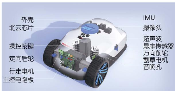
图 12 割草机器人内部结构 (初步)
