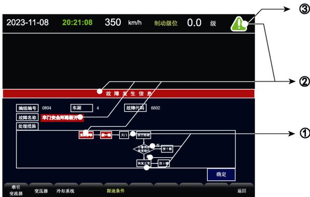
图2 弹出故障界面可视化设计方案
